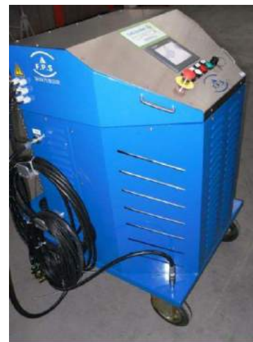
Appareil de récupération, de vidange, d'épreuve et de transfert de GNV de marque FPS
