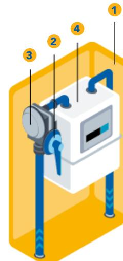
**2 L'organe de coupure individuel du logement:** situé avant le compteur, il permet de fermer le passage du gaz (en cas de travaux ou d'absence prolongée par exemple).
